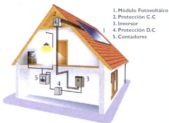
Figura 2.3 Circuito de distribución en una casa alimentada a partir de celdas fotovoltaicas y conectada a la red
