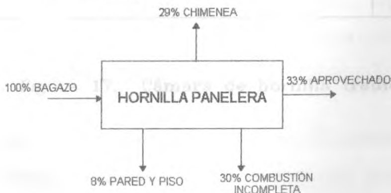
Figura 16. Balance energético en las hornillas tradicionales.
