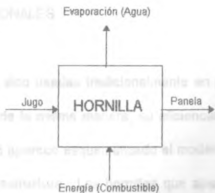
Figura 12. Esquema de funcionamiento de una hornilla.
