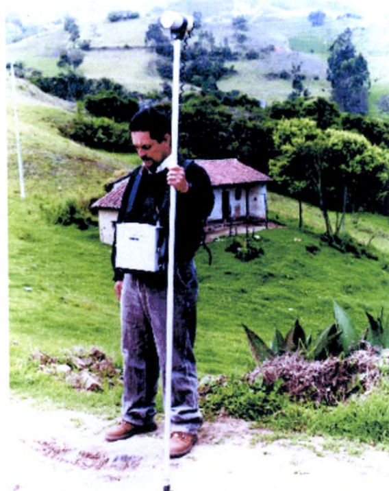
Lectura magnetómetro. Proyecto Ubaté. (Foto: Germán Reyes, 2001).
