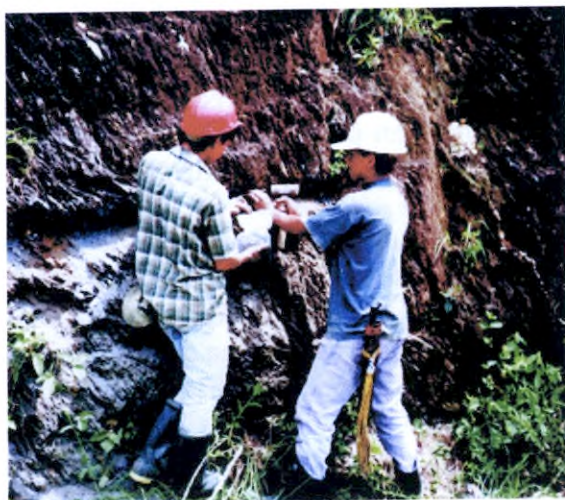
Muestreo en canal, proyecto aurífero Titiribi, Antioquia. (Foto: Victor M. Carrillo, 1998).
