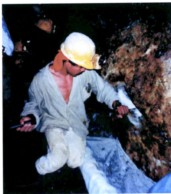
Muestreo en canal, tunel La Palma, Echandía, Marmato, Caldas. (Foto: Luis Bernal, 1995).
