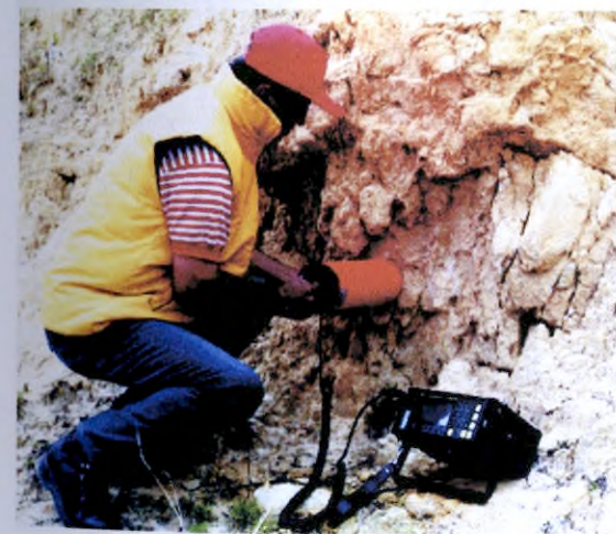
Especrometría Rayos Gamma. Proyecto Ubaté. (Foto: Germán Reyes, 2001).
