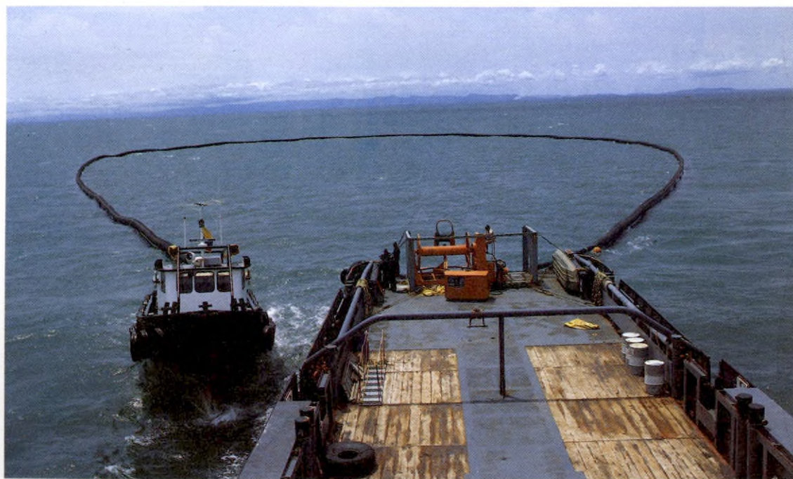
Golfo de Morrosquillo Equipos utilizados para el control de derrames de hidrocarburos
