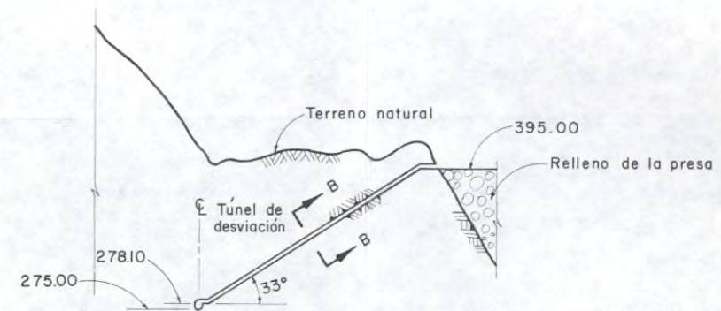
GALERIA DE ACCESO CORTE A-A Escala "A"
