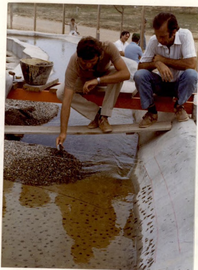
Avance de la preatagüa A. Se aprecia la simulación de la descarga de una volqueta de 35 Tons.
