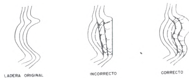
Figura 18 . Adaptación de las proyecciones en planta de los vertederos a la fisiografía.
