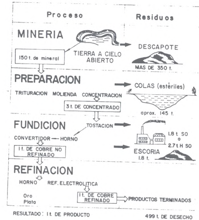
Fig. 4. Etapas y residuos para producir una tonelada de cobre. (Adaptado de Snezhko, 1985).
