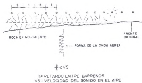
Figura 17. Progresión de una voladura a lo largo de un frente y simulación de la onda aérea.
