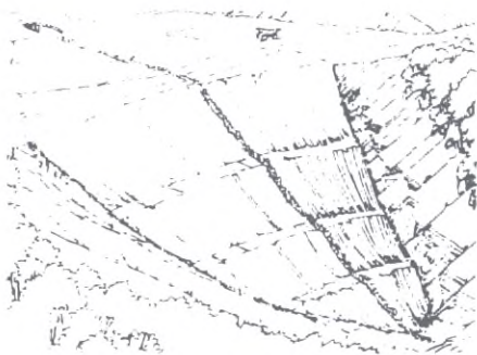
Figura 14. Escombrera de vaguada construida por tongadas y con núcleo central de drenaje.
