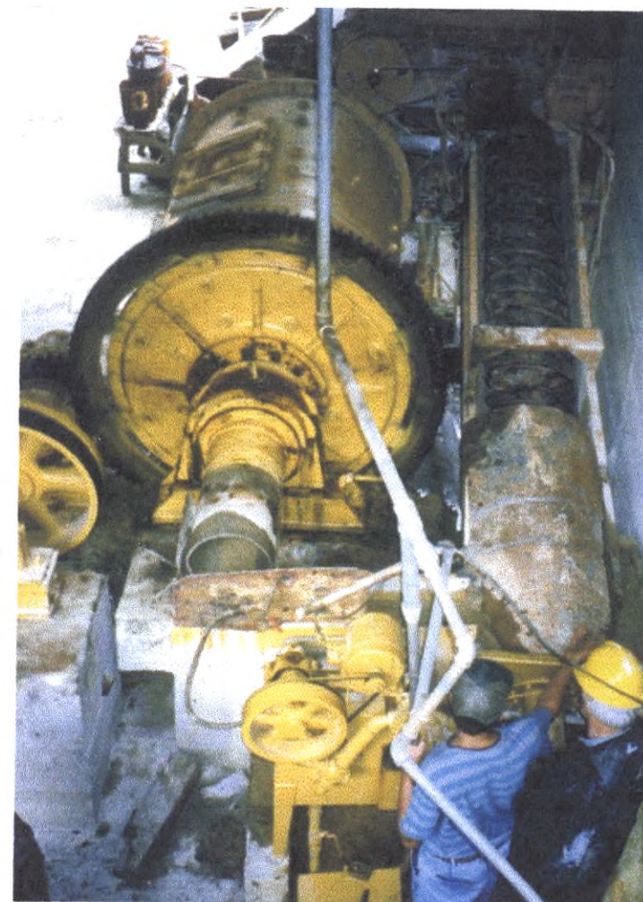
Figura 8. Molino de Bolas en el distrito minero Vetas-California, 1998
