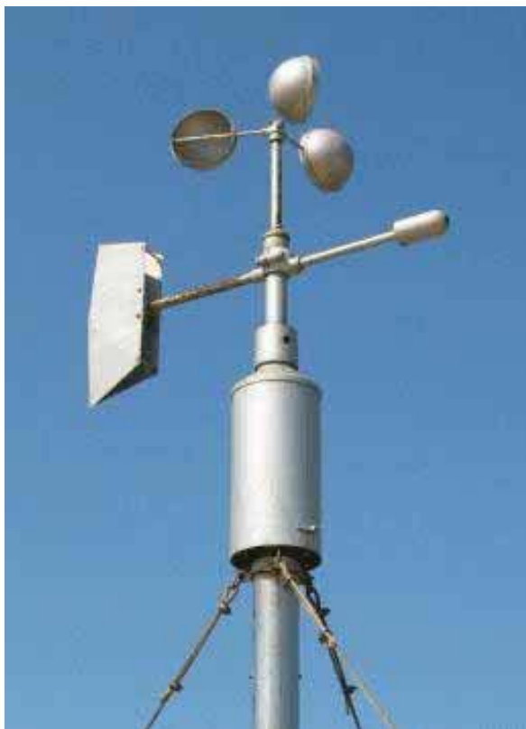
Figura 2-4. Anemómetro de cazoletas o cubetas.
