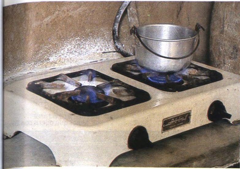
Estufa adaptada para Biogas
