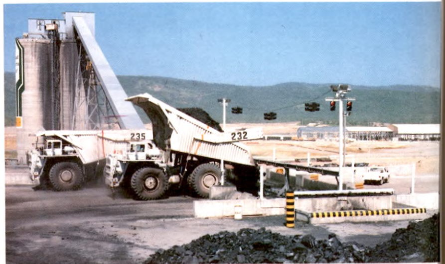
Cerrejón Zona Norte: operación de descargue de carbón en la trituradora.
