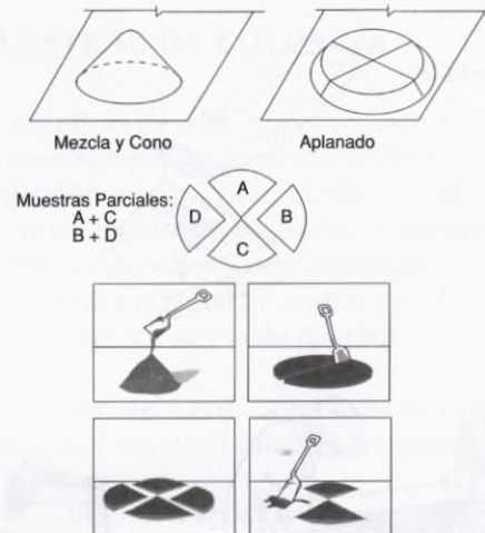
FIGURA 9 CUARTEO MEDIANTE CONO
