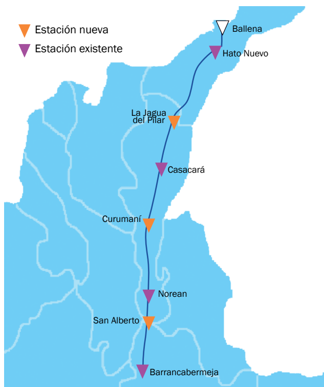
GRÁFICA 3. ESQUEMA DEL PROYECTO DE EXPANSIÓN DEL SISTEMA DE GASODUCTOS DESDE BALLENA
