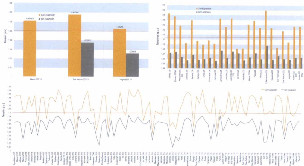
Gráfica 6-60. Tensiones en subestaciones del Suroccidente en estado estacionario para el año 2018, con y sin Alternativa 4 (2 unidades en línea: 1 Salvajina y 1 Betania, y sin intercambios con Ecuador)
