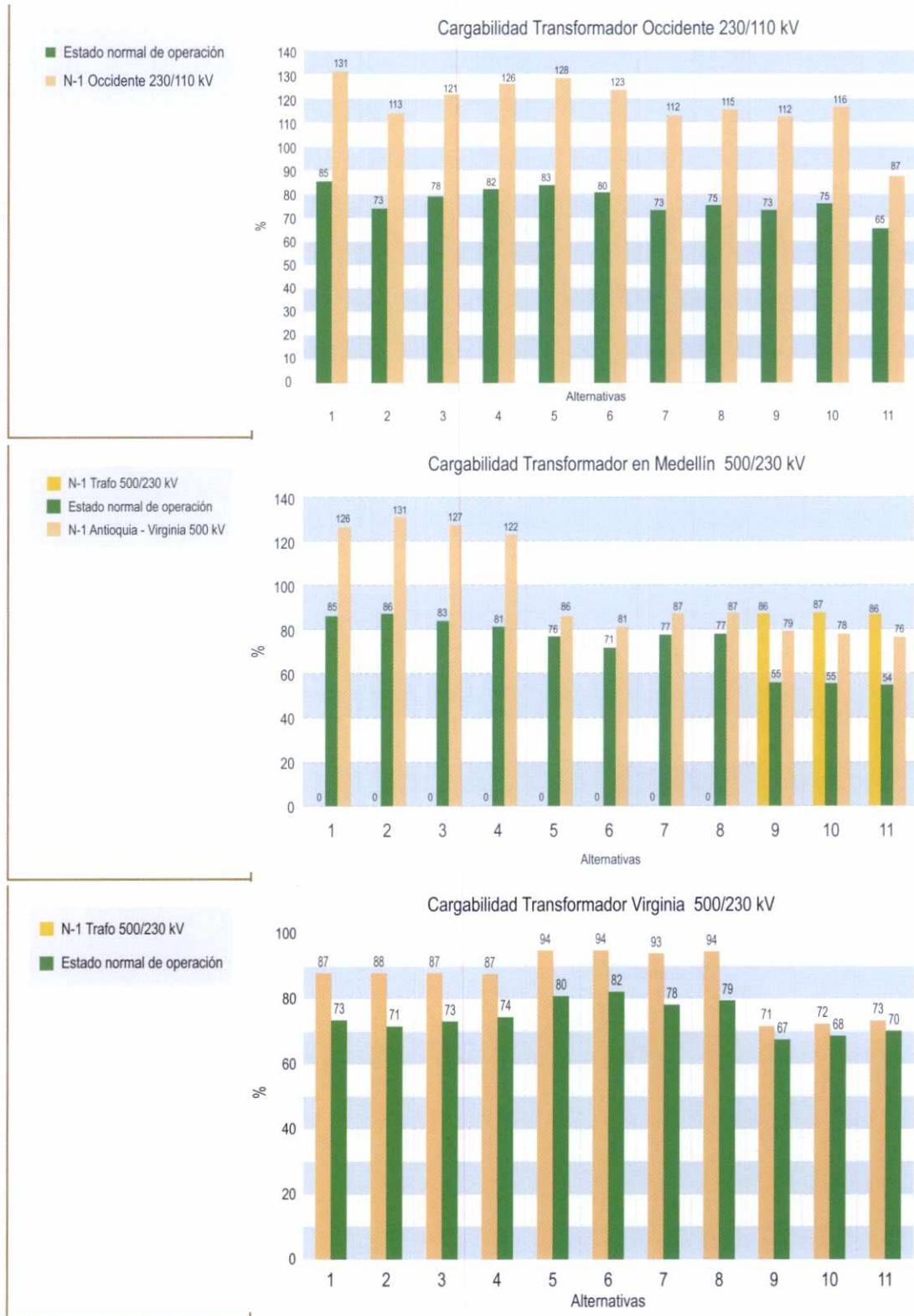
Gráfica 6-37. Cargabilidad de los principales elementos en el área Antioquia. Escenario 2 (baja generación en el norte de Antioquia). Año 2020.
