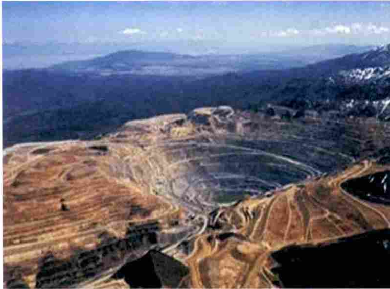
Explotación por bancos o terrazas Fuente: Mina Kennecott (Utah, Estados Unidos)
