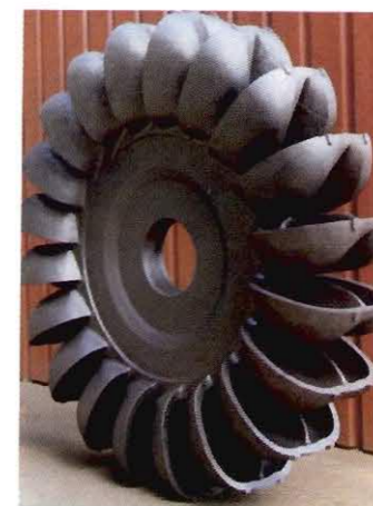
Figura 3- 11 Rodete De Turbina Tipo Pelton 2 .
