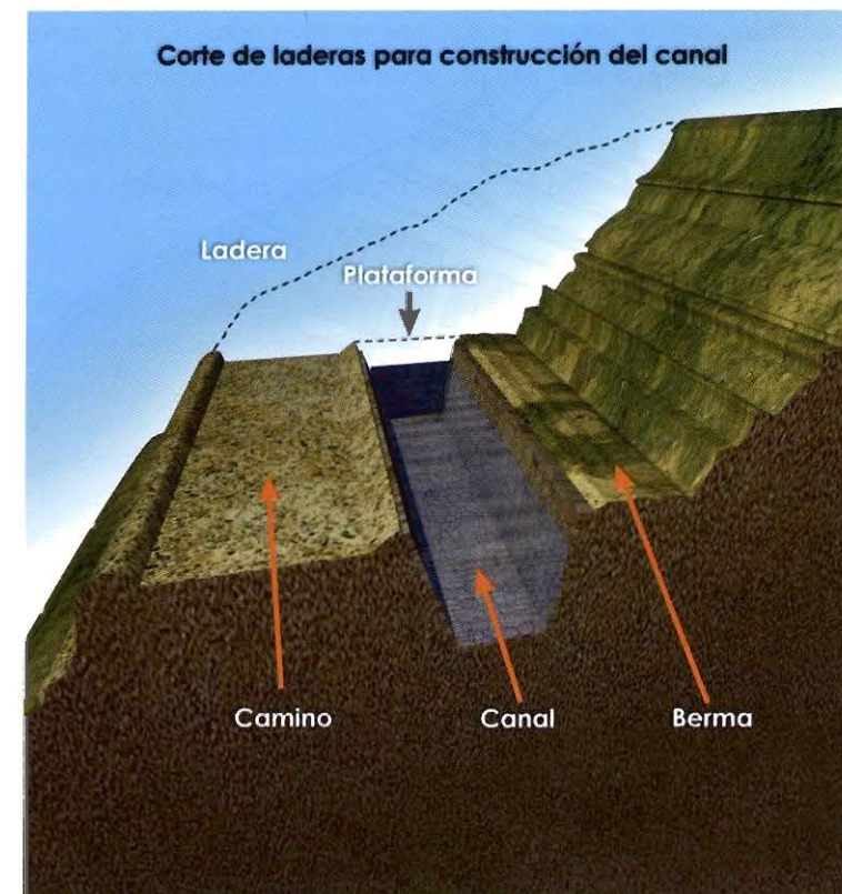
Figura 3-7. Corte de laderas para construcción del canal
