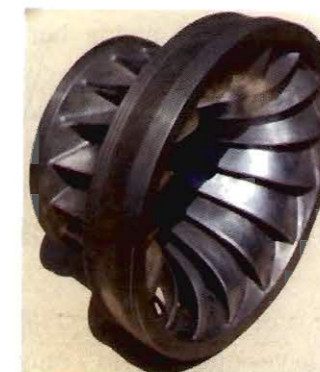
Figura 3- 12 Rodete De Una Turbina Tipo Francis 3
