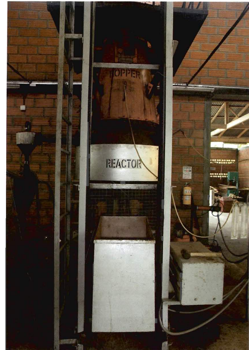
Figura 4-13. Reactor del Gasificador lecho fijo de biomasa leñosa
