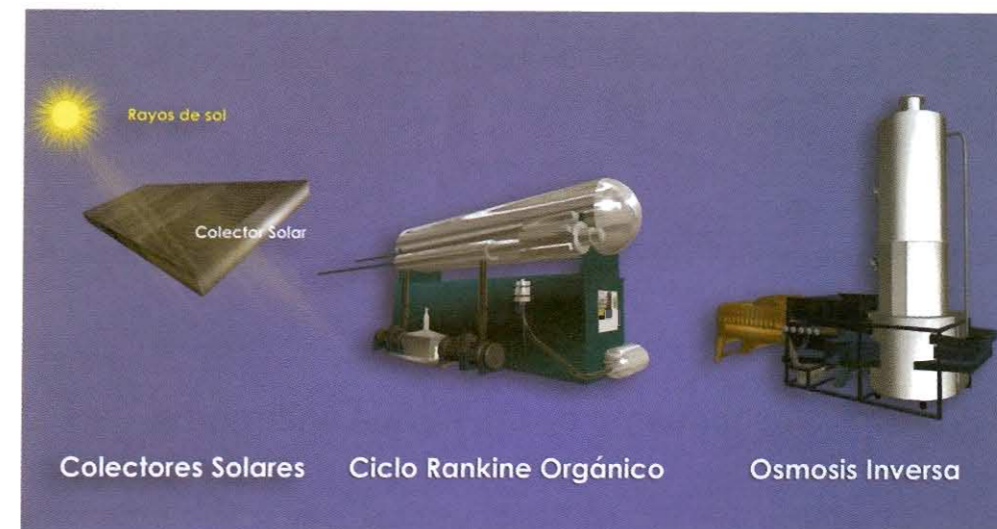
Figura 6-2. Innovador sistema de desalinización con un Ciclo Rankine Orgánico
