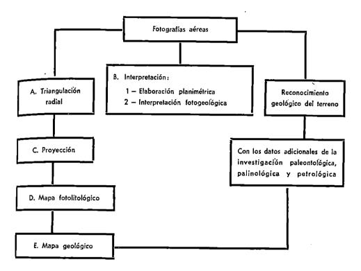
Nota: Cuando no existen planos topográficos con curvas de nivel, se pueden calcular de las fotografías con la ayuda de un estereómetro, las alturas relativas de una serie de puntos situados en una línea (línea de perfil), luégo con el mapa geológico ya confeccionado, se puede construir un perfil geológico y la columna estratigráfica.
