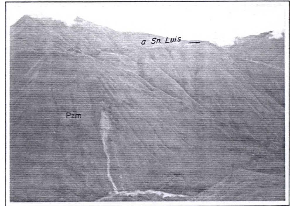
FOTO 35._ Afloramiento de roca en el estribo izquierdo de la presa (Pzm). Complejo de Macama.
