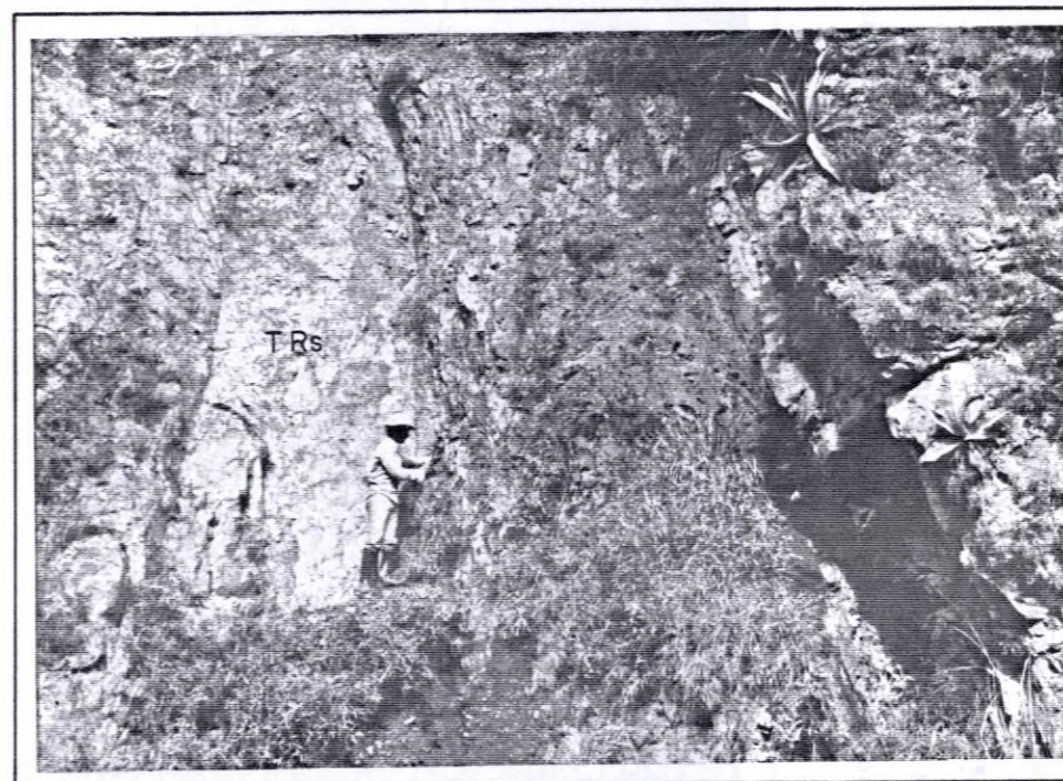
FOTO 46._ Muestra zona de cizallamiento, 200m. al norte del sitio presa de Guinea, afectando rocas volcánicas (Formación Saldaña) TRs.
