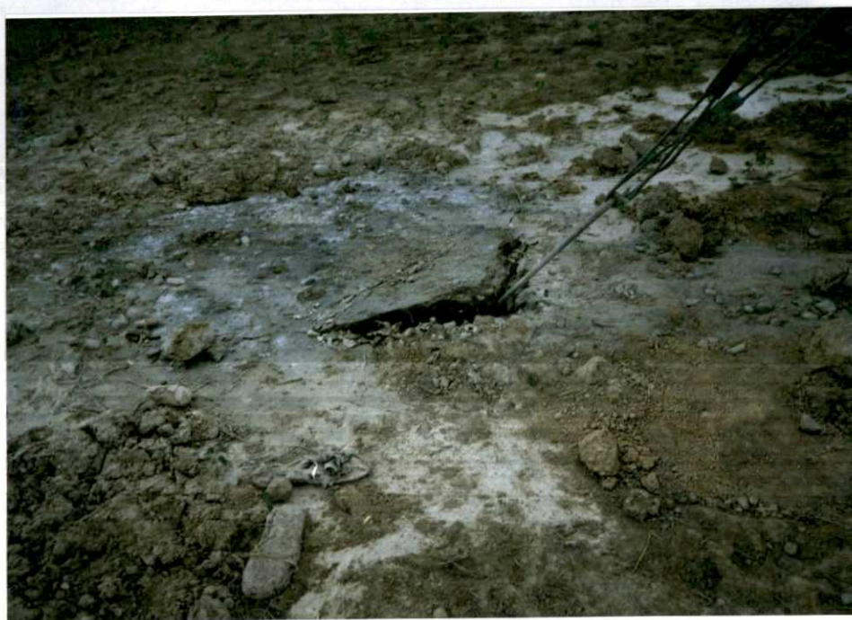
ANCLAJE CON RELLENO DE MATERIAL SELECCIONADO Y CONCRETO CICLOPEO QUE NO RESISTIO LAS PRUEBAS DE TENSION. (OBSERVENSE LAS FISURAS EN LA CIMENTACION)
