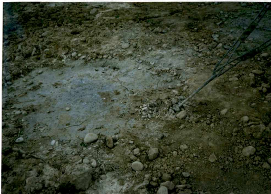
ANCLAJE CON RELLENO DE MATERIAL SELECCIONADO Y CONCRETO CICLOPEO QUE NO RESISTIO LAS PRUEBAS DE TENSION. (OBSERVENSE LAS FISURAS EN LA CIMENTACION)
