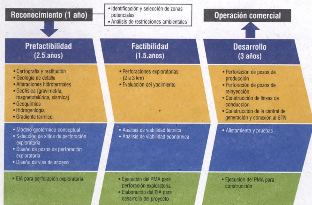
Diagrama de flujo para el desarrollo de un proyecto geotérmico 19 .
