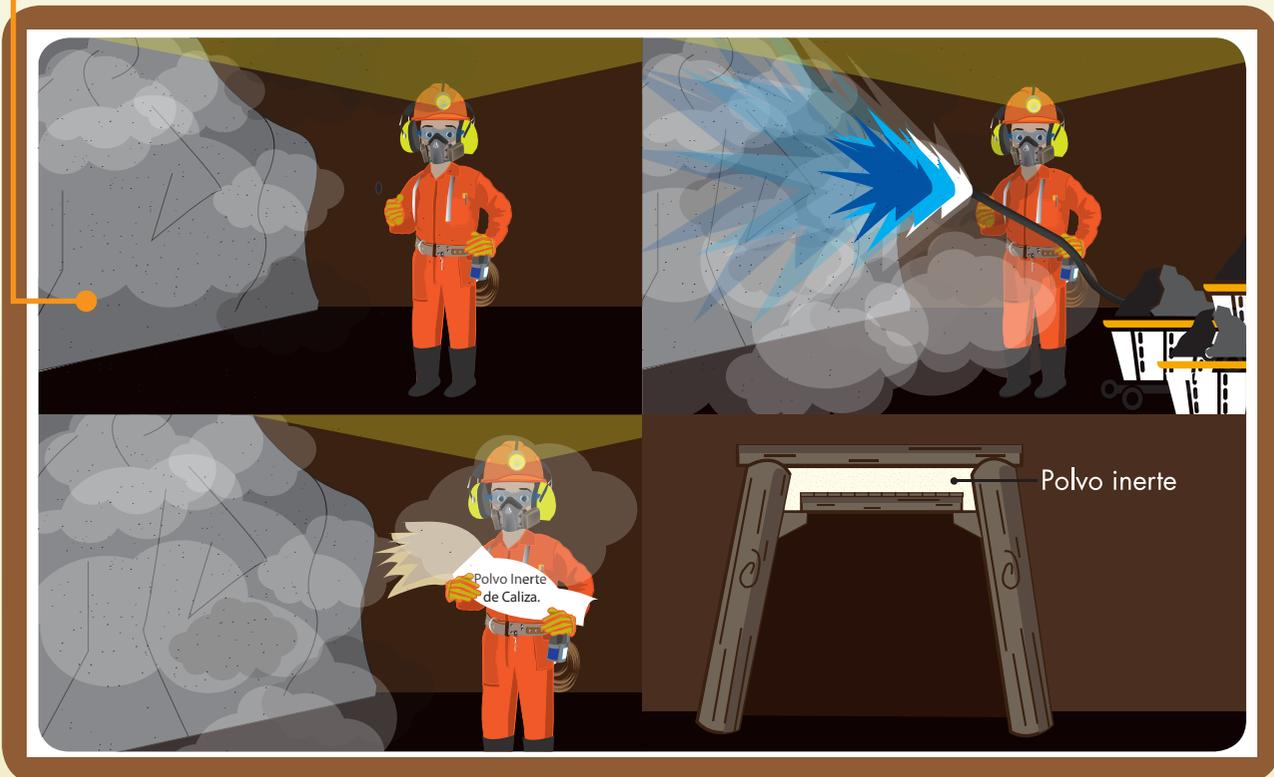
Contra la propagación de explosiones de polvo de carbón, se deben instalar barreras de polvo inerte de caliza o recipientes con agua.
