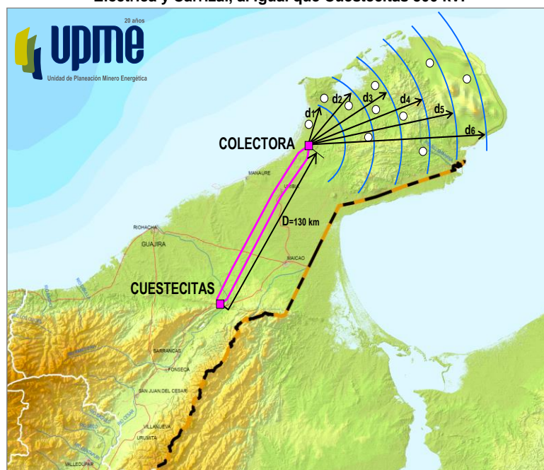
Gráfica 5-256: Desplazamiento de la subestación Colectora 500 kV, respecto a la ubicación de los parques Irraipa, Casa Eléctrica y Carrizal, al igual que Cuestecitas 500 kV.
