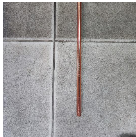
Varilla de cobre comercializada como Electrodo de puesta a tierra 1,2m sin marcación
