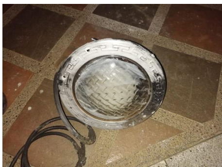
Ilustración 52 Luminaria para uso en piscinas con bombillo halógeno de 400 W / 120 V, dañada por uso inadecuado
