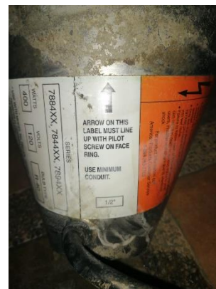
Ilustración 52 Luminaria para uso en piscinas con bombillo halógeno de 400 W / 120 V, dañada por uso inadecuado
