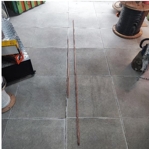
Comparación de longitud entre productos comercializados como electrodos de puesta a tierra
