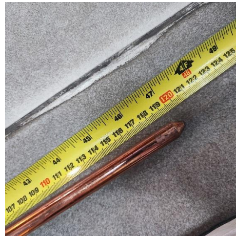
Medida de Varilla de cobre comercializada como Electrodo de puesta a tierra 1,2 m
