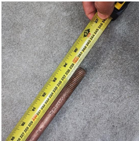
Electrodo de puesta a tierra tipo varilla de 2,4 m sin marcación
